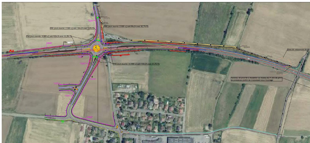
Figure 8 : Vue en plan de la variante 1 (Source : AVP, Carrefour giratoire et aménagements connexes à Heyrieux, 29/06/2022)
